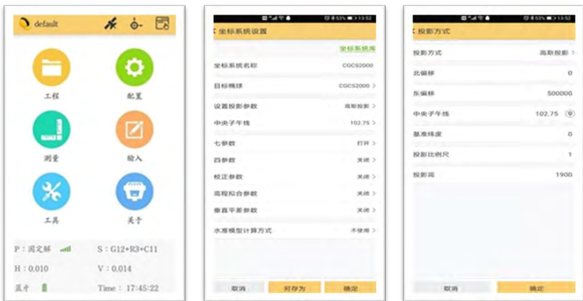
图 4-23 昆明 2000 坐标系统设置界面
