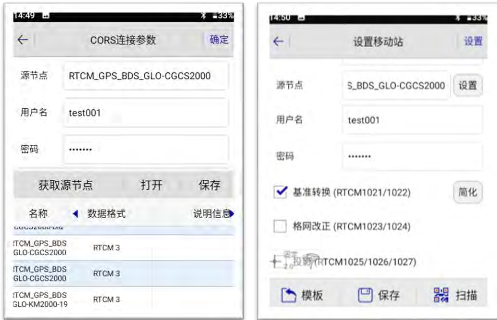
图 4-12 CGCS2000 坐标系源节点设置界面
