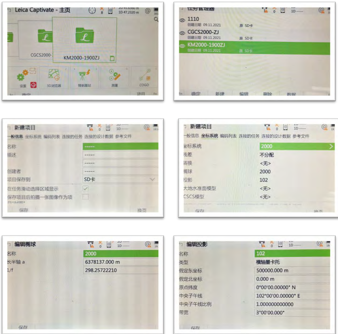
图 4-27 新建工程及坐标系统设置过程
