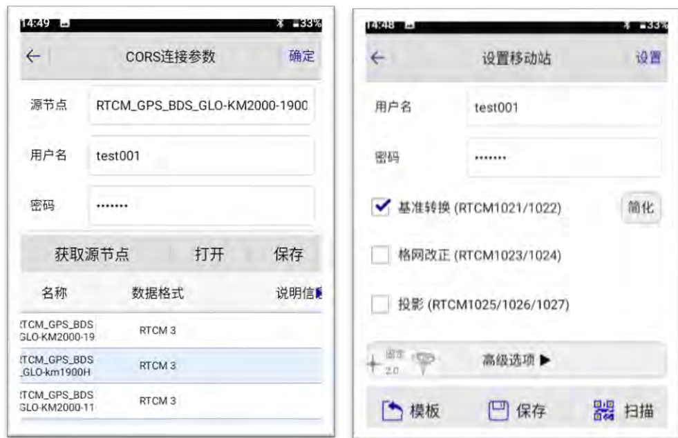
图 4-13 昆明 2000 坐标系源节点设置界面
