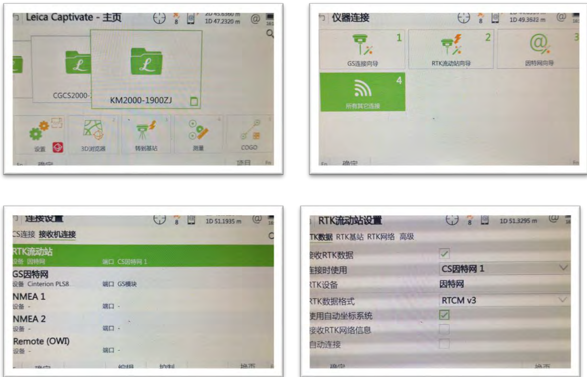
图 4-28 RTK 流动站设置过程
