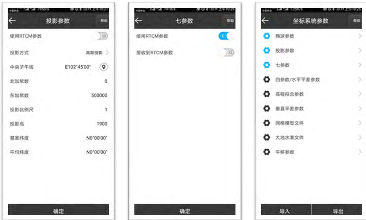
图 4-18 昆明 2000 坐标系统设置界面
